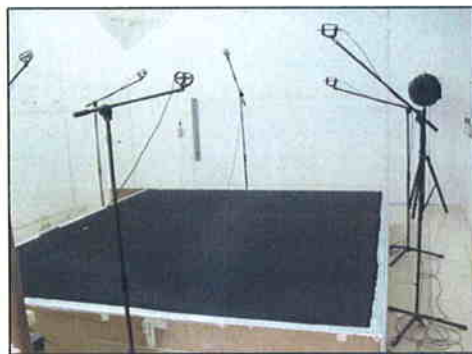
Imágenes 8 y 9 Preparación y muestra preparada para el ensayo 2 (con cámara de aire)
