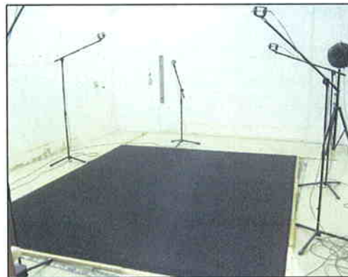
Imágenes 6 y 7 Preparación y muestra preparada para el ensayo 1 (sin cámara de aire)
